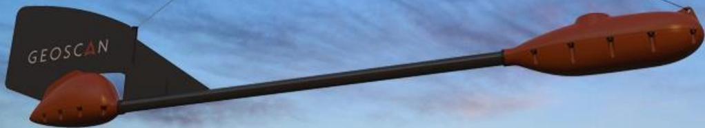
Технология аэромагнитной съемки с огибанием рельефа, с использованием БПЛА оснащенного высокочувствительным квантовым магнитометром (Rb) и спутниковым GNSS-приемником в непрерывном режиме позволяет получать качественные и надежные исходные данные для интерпретации на основе современных методов.
